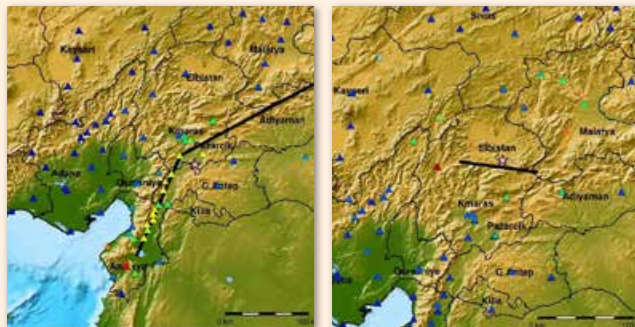
Εικόνα 12: Χωρική κατανομή των μέγιστων εδαφικών επιταχύνσεων (PGA) σε τιμές του g για τον πρώτο σεισμό M_w=7,8 (αριστερά) και για τον δεύτερο σεισμό M_w=7,6 (δεξιά) (Cetin et al. 2023).
