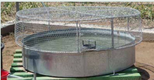
Εικόνα 2: Εξατμισόμετρο τύπου λεκάνης τοποθετημένο σε σταθμό καταγραφής εξάτμισης του Τμήματος Μετεωρολογίας.
