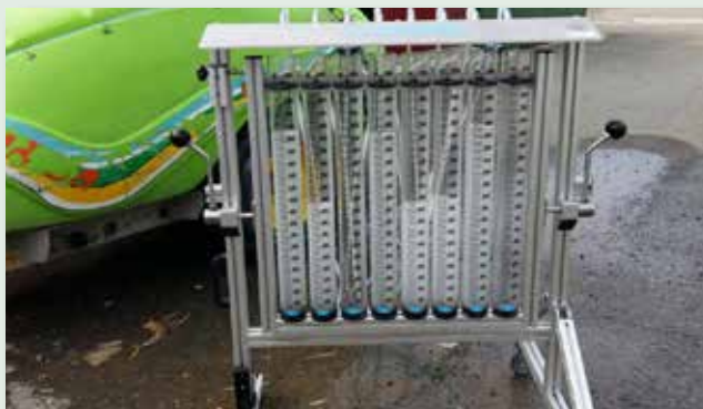
Ανομοιομορφία κατανομής του ψεκαστικού υλικού από τα ακροφύσια
