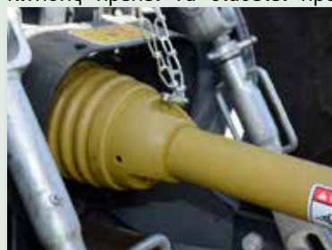
Άξονας μετάδοσης κίνησης με το προστατευτικό κάλυμμα και τις αλυσίδες
