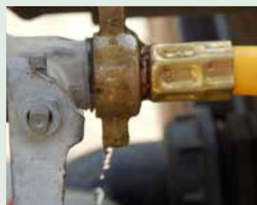
Διαρροή σε σημείο συνδεσμολογίας
