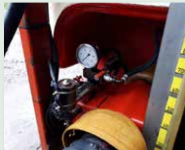
Μανόμετρο 25 ατμ. τοποθετημένο σε θέση ώστε να είναι ορατό και ευανάγνωστο από τον χειριστή
