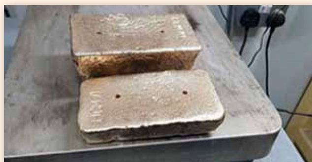
Κράμα χρυσού-αργύρου όπως παράγεται σήμερα στις εγκαταστάσεις του Μεταλλείου της Σκουριώτισσας
