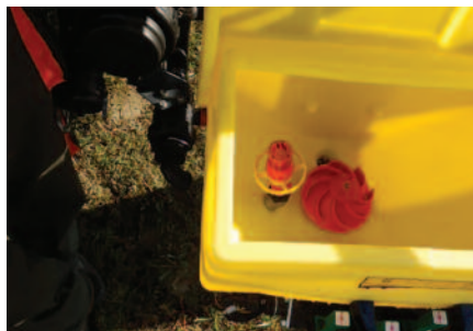
Μηχανισμός ανάμιξης και διάλυσης φυτοπροστατευτικών ουσιών
